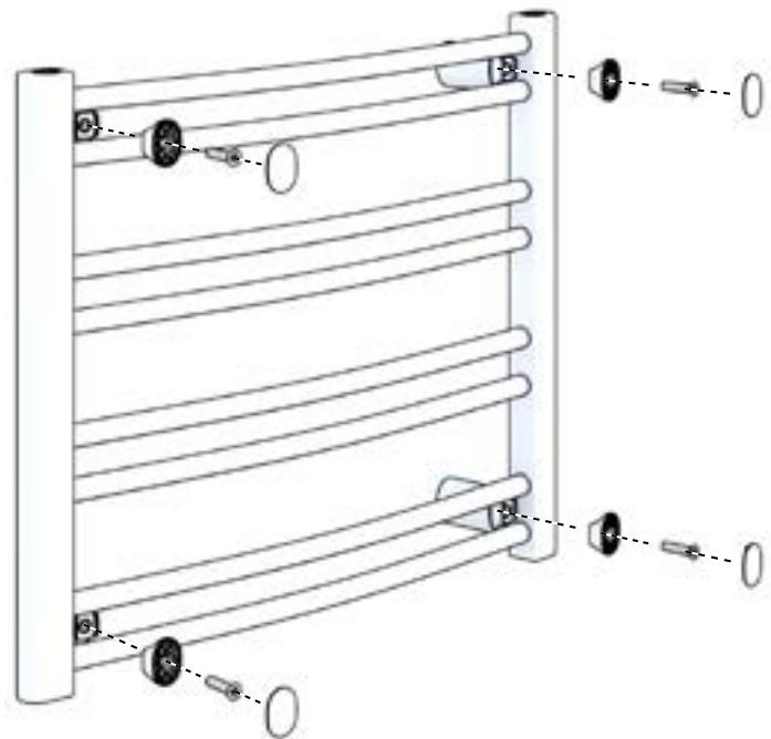
Häng upp torken och skruva fast hållaren, täck över med täckbricka.
